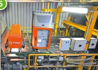
Der durch den **Polysort** geführte Abfall wird optisch (Infrarotlicht) auf seine stoffliche Zusammensetzung geprüft. Erkennt das Messsystem z. B. ein Kunststoffteil, wird dieses gezielt mittels Druckluft vom Förderband „geblasen“.
