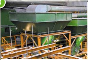
Im **Windsichter** wird die mittelgroße Fraktion in Stoffe mit unterschiedlicher Dichte (Schwergut und Leichtgut) getrennt. Leichtes Material wird durch einen Windstoß „weggeblasen“; Schweres fällt auf ein Förderband nach unten.
