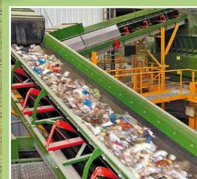
Ziel der mechanischen Aufbereitung ist die Abtrennung von Fraktionen, die für die energetische Nutzung geeignet sind. Die Zerkleinerung erfolgt in mehreren Schritten, um die jeweiligen Fraktionen zu trennen und zu dokumentieren.
