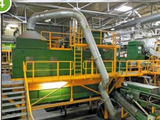
Im **Bogenbandsichter** wird der Stoffstrom über einem Beschleunigungsband abgeworfen. In die Wurfparabel wird ein Bogenband eingefahren und ein Luftstrom in Richtung des Bogenbandes erzeugt. Das Leichtgut wird so über das Bogenband abgefördert. Das Schwergut fällt auf ein Abzugsband.
