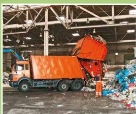
Nach der Verwiegung der Abfälle auf der Eingangswaage werden diese in der Anlieferhalle getrennt nach Restabfall und Sperrmüll entladen und nach der Störstoffentfernung durch einen Radlader bzw. Greifbagger dem Vorzerkleinerer zugeführt.
